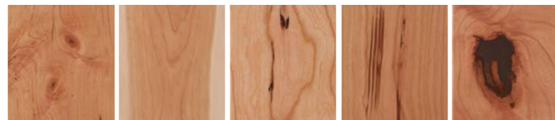
ノット・ビンノット (節・葉節) サップウッド (白太) ガムポケット (樹脂痕) ミネラルストリーク (かなすじ) バテ充填処理
