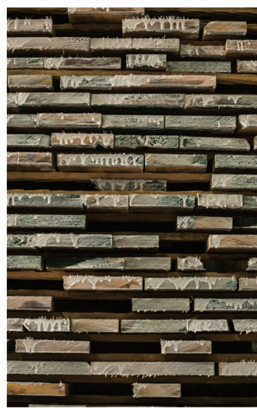
木口に割れ止めの口を塗り、天然乾燥工程へ
