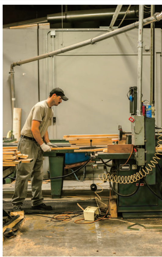
幅カットの工程
